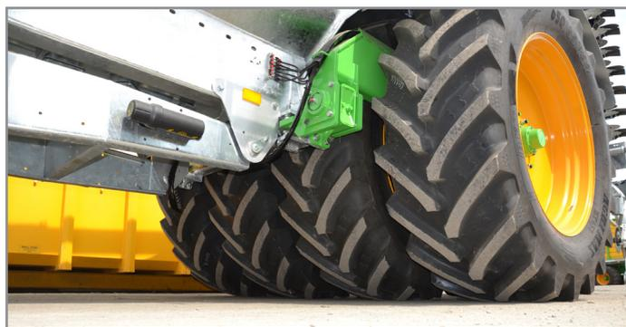
*Les 4 roues de même dimension 650/85R38 (Ø 2.070 mm) alignées côte à côte permettent de répartir uniformément la majeure partie du poids du véhicule au sol.*
